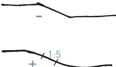
Illustrationsskitse teknisk skråning og s-formet kurve
